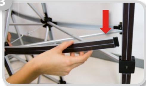
Führen Sie zuerst alle horizontalen und danach die vertikalen Stützstreben in die schwarzen Schienen.
